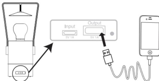
« Output » et raccordez l'autre côté à votre appareil électronique (consultez également le mode d'emploi de votre appareil). Le processus de charge démarre automatiquement.
